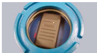
Бесконтактное устройство считывания карт компании Smith
