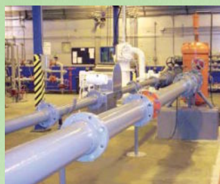
Стендовая система для проверки в широком диапазоне вязкостей
