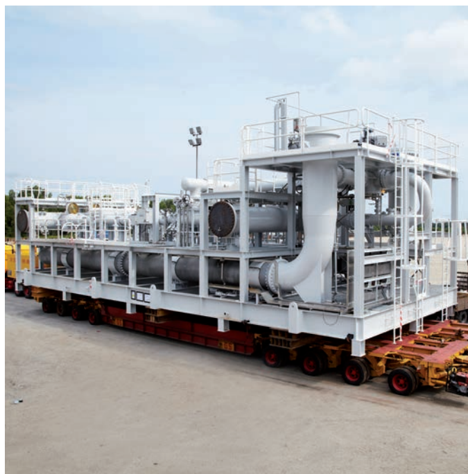
Система измерения расхода на основе ультразвукового расходомера с двунаправленным шаровым пружером, расположенным под измерительным участком
