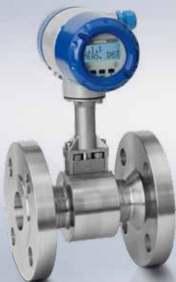
OPTISWIRL 4070 C фланцевая версия Универсальный прибор со встроенной компенсацией по температуре для насыщенного пара и опционально доступной компенсацией по давлению для перегретого пара, газов, влажных газов
