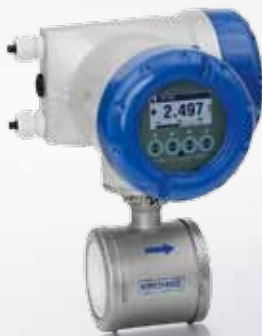
OPTIFLUX 7300 версия "сэндвич" С емкостными электродами, не контактирующими с измеряе- мой средой и керамической футеровкой
