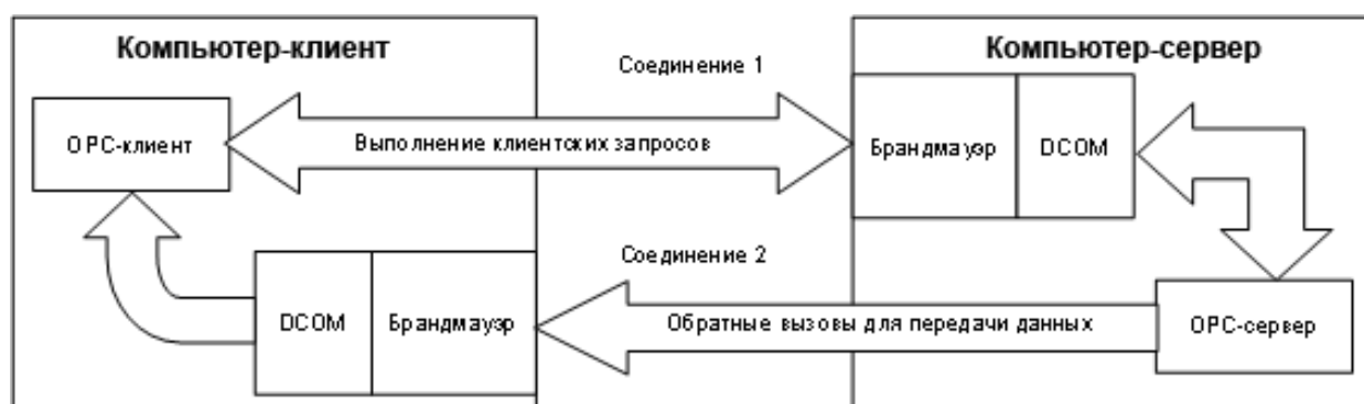
Рисунок 1.1 — Схема взаимодействия с OPC-сервером
