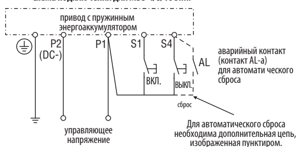
Схема подключения для MDS-4/8/16 S....
