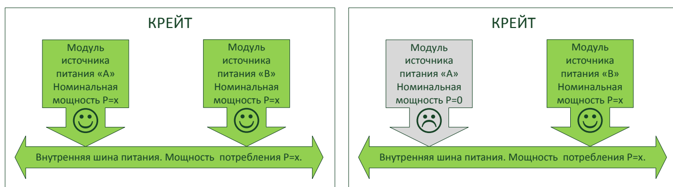
Рисунок 7 - Схема со 100% резервированием модулей источников питания
