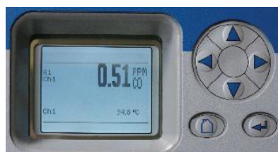
Увеличенное изображение графического дисплея анализатора X-STREAM Enhanced, на котором результаты измерений и данные о состоянии отображаются посредством незашифрованного текста и символов.
