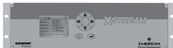
Изображение графического дисплея анализатора X-STREAM Enhanced, на котором результаты измерений и данные о состоянии отображаются посредством незашифрованного текста и символов.
