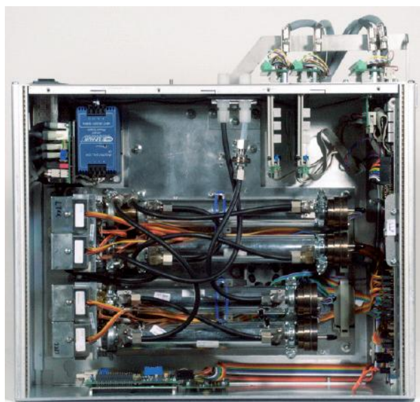
Вид изнутри: четыре модуля NDIR, термореле (без крышки), аналоговые выходы и выходы реле, цифровые входы, последовательный интерфейс и винтовые клеммы (опция).
