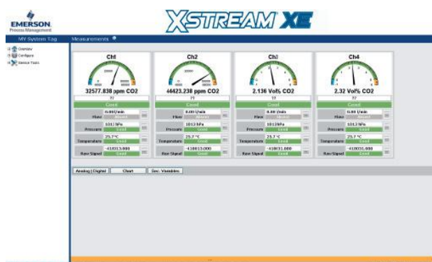
Веб-браузер отображает измеренную концентрацию и вторичные данные
