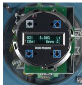
Корпус электронной части с локальным интерфейсом оператора и инфракрасными кнопками, нажимаемыми через стекло
