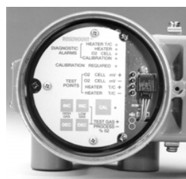
Полевой электронный блок анализатора Oxymitter 4000 монтируется прямо на кислородном зонде в стандартном корпусе NEMA 4X, IP 66.
