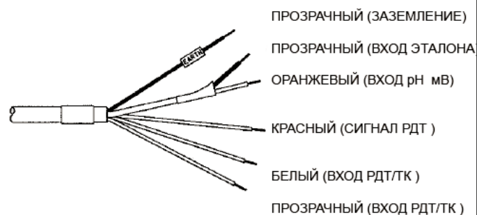
Конфигурация проводки опции -62
