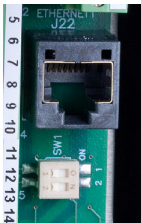
Рис. 3-11: Переключатель SW1 на объединительной плате
