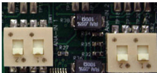
Рис. 3-25: Заводская настройка аналоговых переключателей входа
