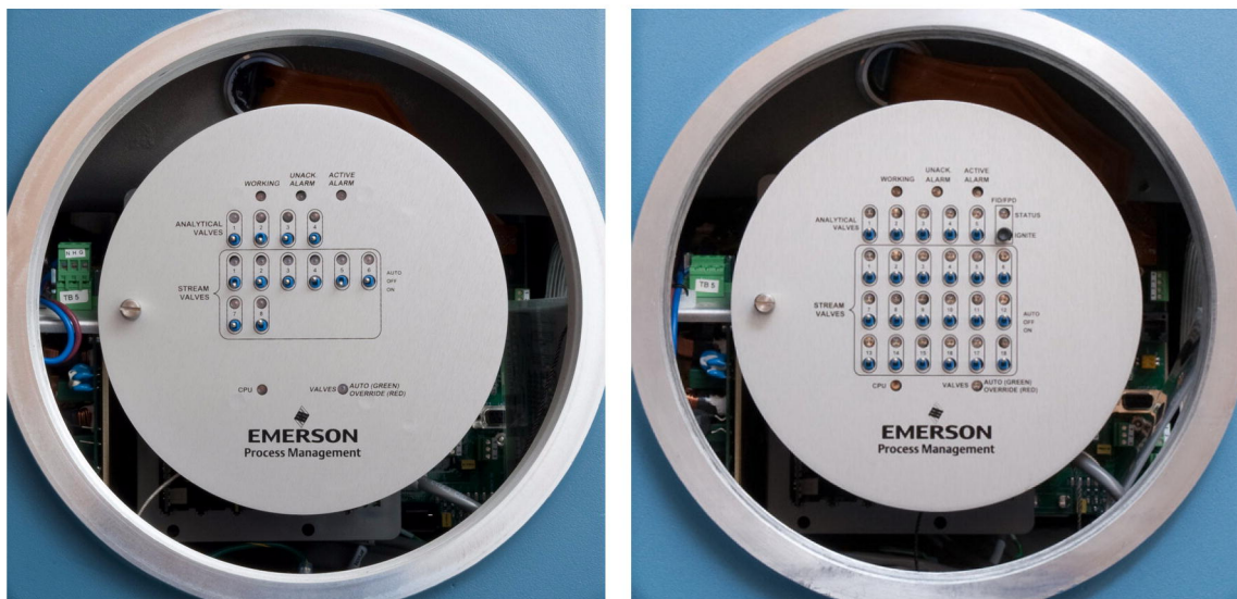
Рис. 2-2: Панель переключателей на 8 потоков (слева) и на 18 потоков (справа)
