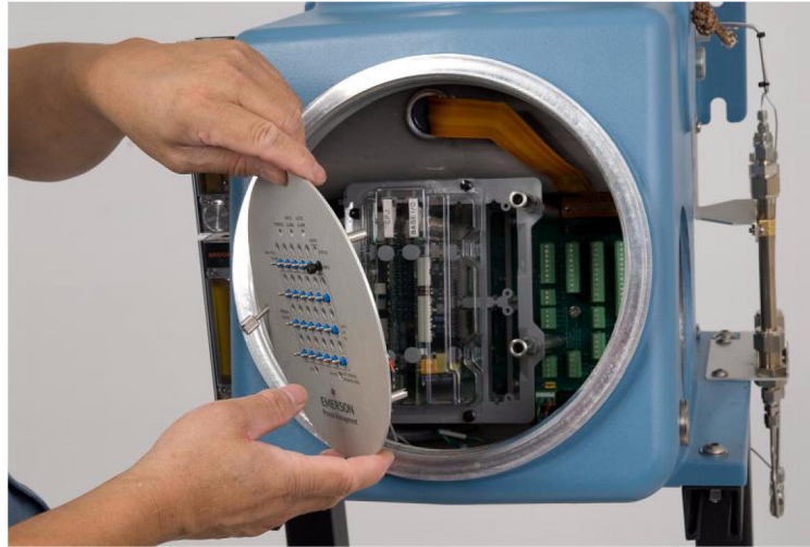
Рис. 4-22: Снимите панель переключателей или локальный интерфейс оператора (LOI)
