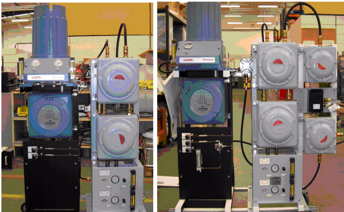
Рис. F-2: Фотометрический детектор пламени 700XA (А) и фотометрический детектор пламени 700XA Front Entry (В)
