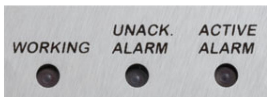
Рис. 2-4: Светодиодные индикаторы состояния (в верхней части панели переключателей)
