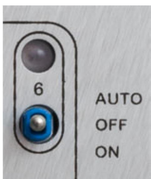
Рис. 2-3: Переключатель клапана на панели в положении OFF (Выкл.)
