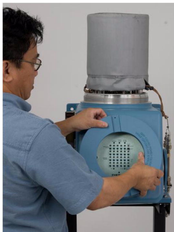
Рис. 4-17: Снимите переднюю панель
