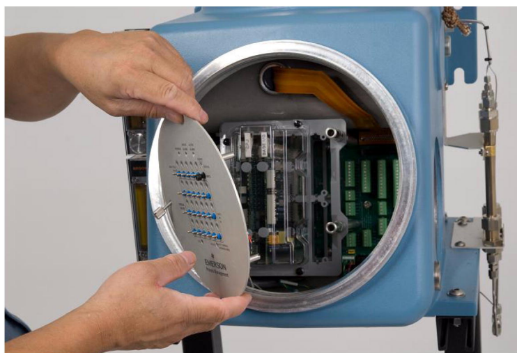
Рис. 4-18: Снимите панель переключателей или локальный интерфейс оператора (LOI).
