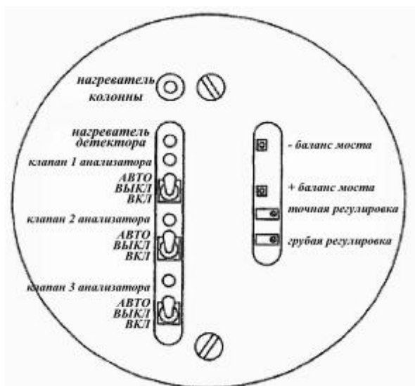
Рисунок 5-2. Переключатели клапанов анализатора, верхний корпус GUB
