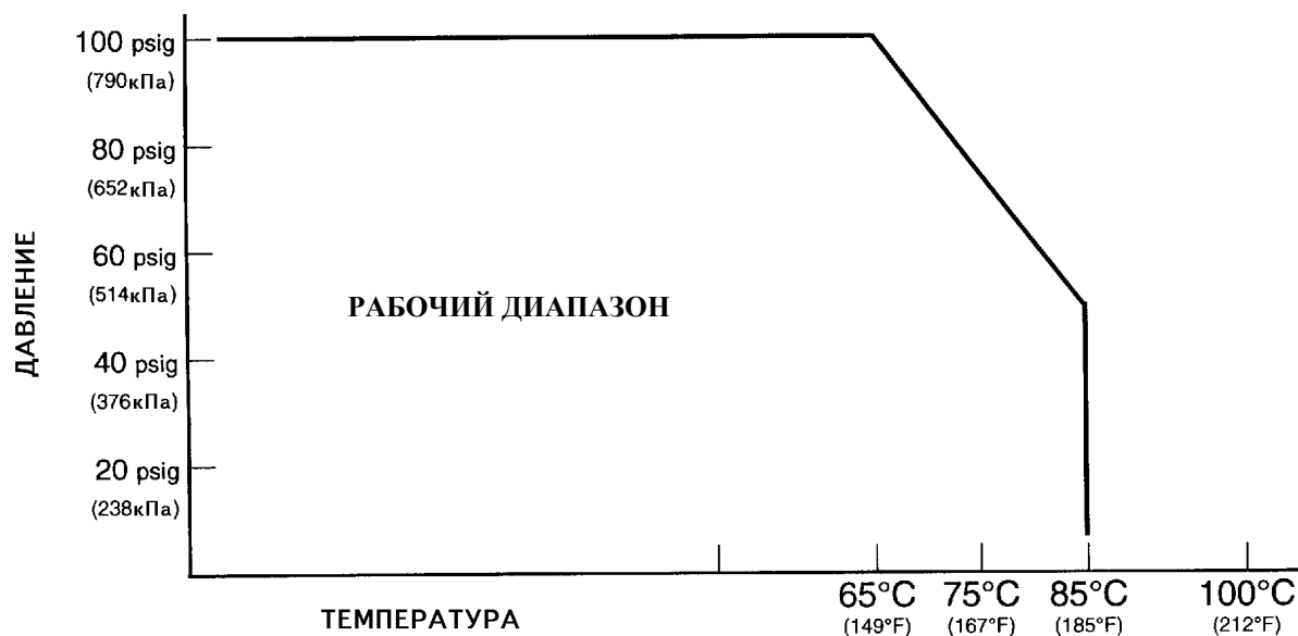
РИСУНОК 1-1. Ограничения работы по давлению/температуре
