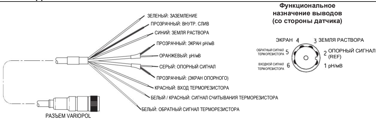
РИС. 4. Функциональное назначение проводов разъема Variopol соединительного кабеля PN 23645-10, 11 и 12
