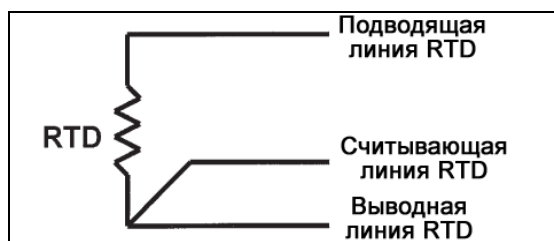
РИСУНОК 10-3. Трехпроводная конфигурация RTD
