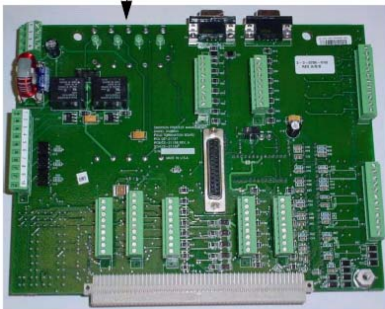
Рисунок 4-9. Контрольные точки полевой оконечной платы (FTB)
