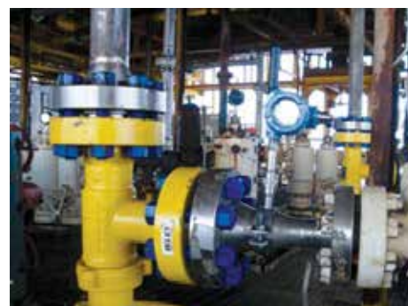
Контроль температуры бурового раствора в промывочной системе с помощью Rosemount 648
