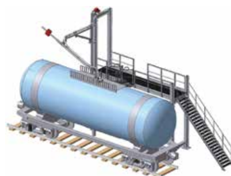
Схема системы налива готового сырья в ж/д цистерну, автоматизированная с помощью беспроводного решения от Emerson
