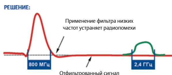
Рисунок 3. Фильтр нижних частот устраняет радиопомехи коммуникационного сигнала на WFN
