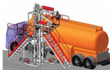
Схема системы налива готового сырья в автоцистерну
