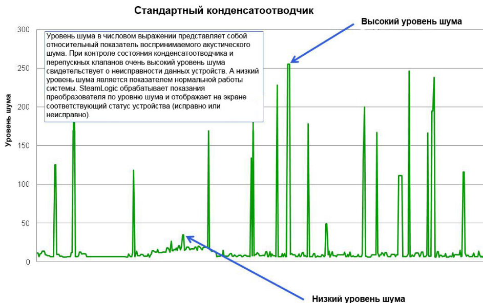
Рисунок 1: Акустические показатели стандартного конденсатоотводчика
