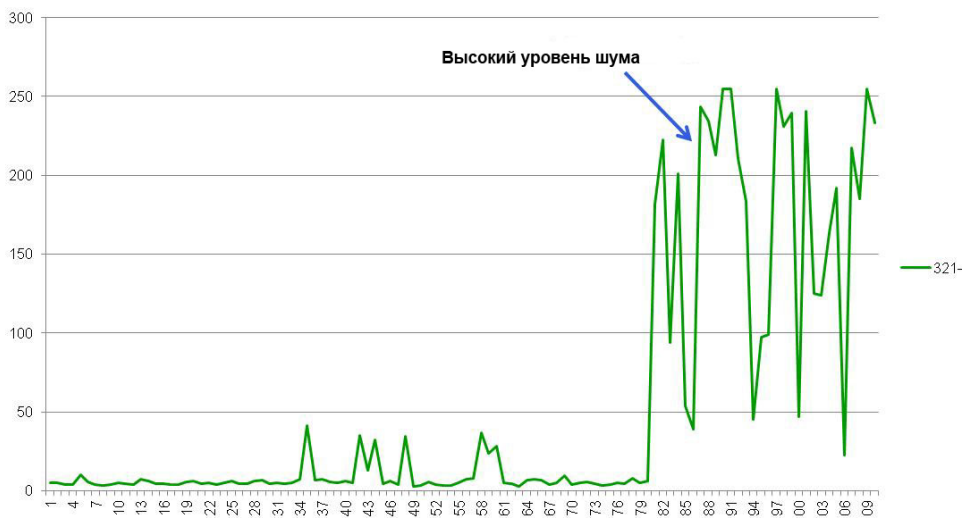
Рисунок 2: Конденсатоотводчик в хорошем состоянии обычно работает при низком уровне шума
