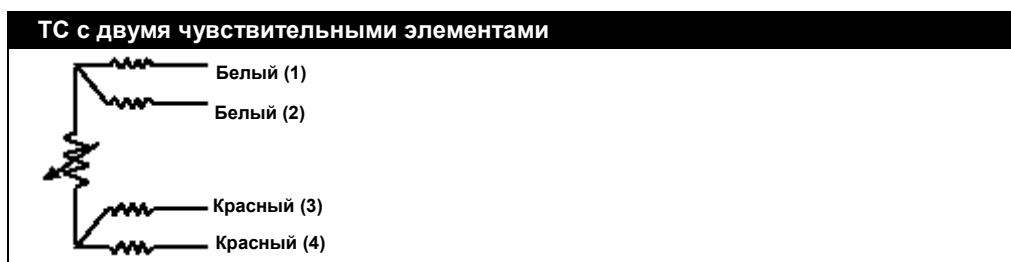
Рисунок 2-4. Конфигурации соединения проводов ТП серии 183
