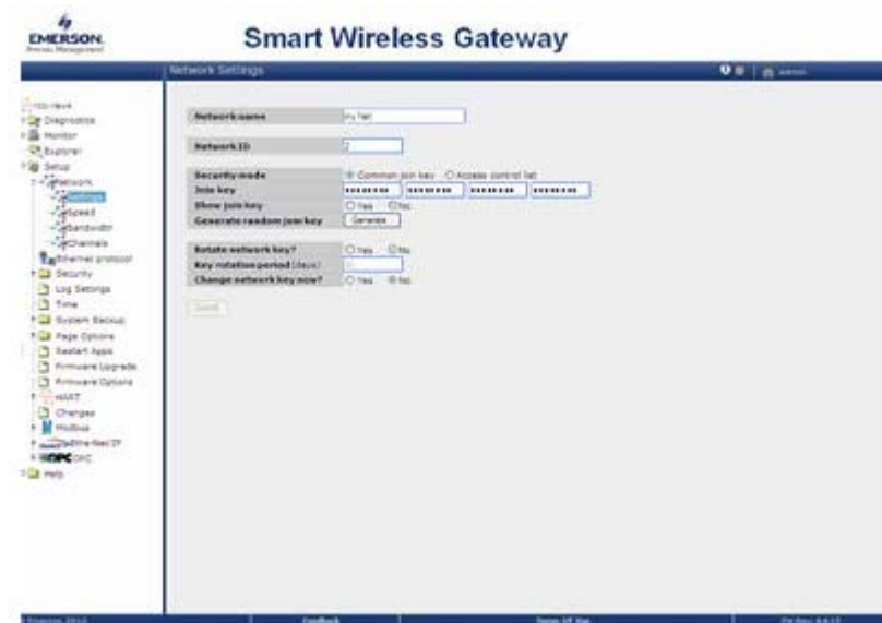
Рис. 4-5. Сетевые настройки интеллектуального беспроводного шлюза SmartWireless
