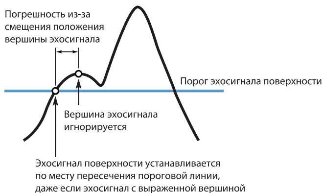
Рисунок 6-11. Тонкий слой нефти на поверхности воды, метод обнаружения эхосигнала по пересечению порога (Threshold Intersection).
