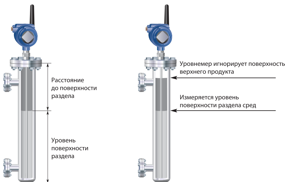
Рисунок 6-16. Измерение уровня границы раздела сред в заполненной камере.
