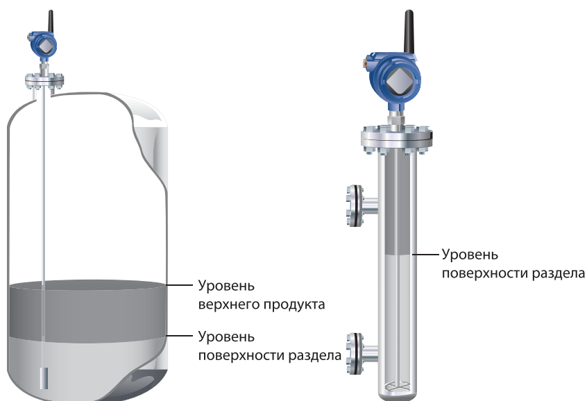
Рисунок 2-5. Измерение уровня границы раздела сред.
