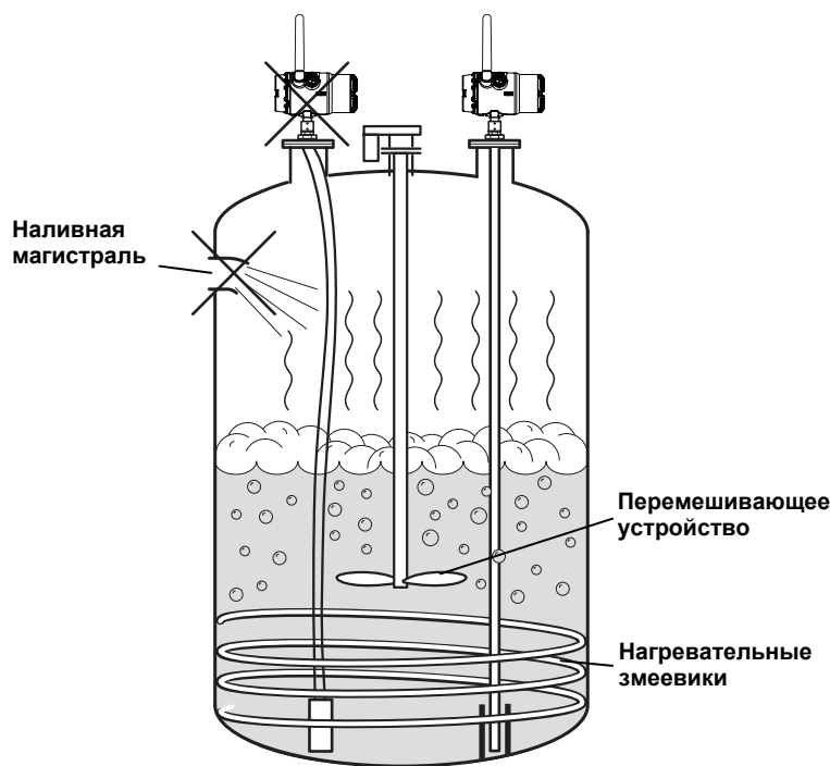
Рисунок 3-1. Размещение уровнемера в резервуаре.
