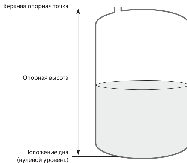
Рисунок 3-4. Измерение высоты резервуара.
