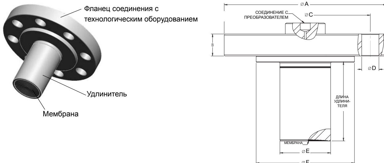
Табл. 81. Размеры фланцевой разделительной мембраны с удлинителем FFW (1)
