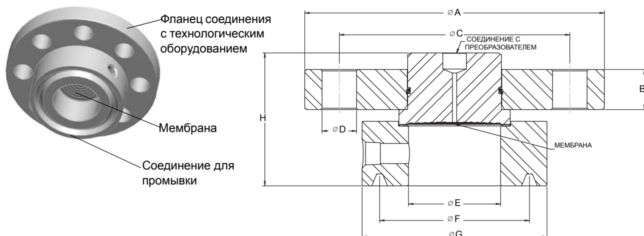
Рис. 22. Фланцевая выносная разделительная мембрана (RCW), с кольцевым соединением (RTJ) и кольцо промывочного патрубка
