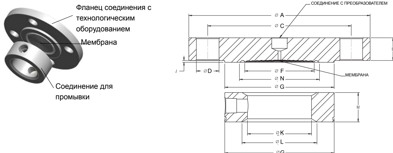
Рис. 16. Разделительная мембрана с фланцевым соединением и возможностью промывки FFW — цельная конструкция (показано с промывочным кольцом)
