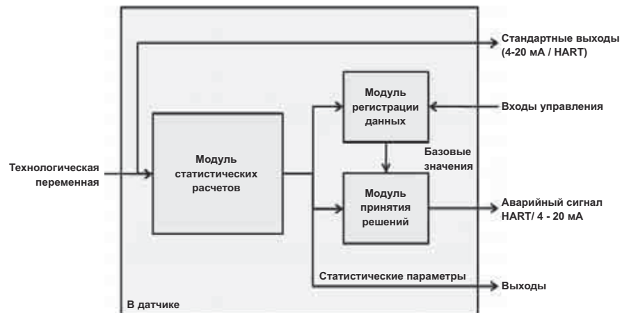
Рис. 7-4. Диагностический компонент статистического мониторинга процесса, расположенный в датчике
