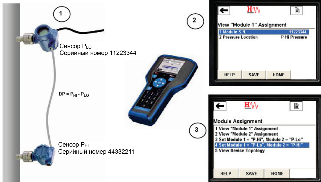
Рисунок 3-6. Пример изменения назначения модулей P HI и P LO
