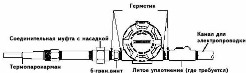
Рисунок 2-3. Рекомендуемая установка с дренажным уплотнением
