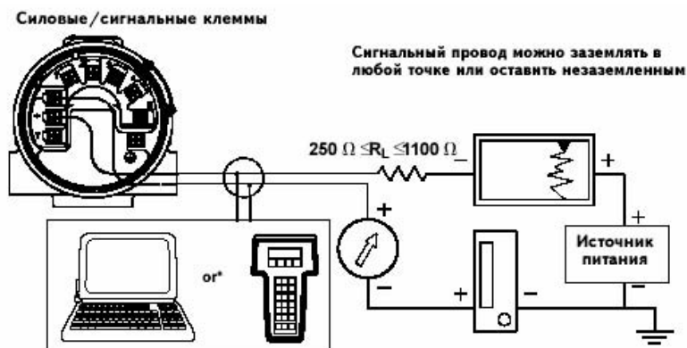
Рисунок 2-10. Соединение коммуникатора с сигнальной петлей датчика (HART /4-20 мА)
