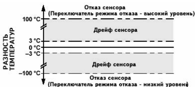
Рисунок 3-5. Отслеживание дрейфа и отказа первичного преобразователя с помощью переменной разности температур
