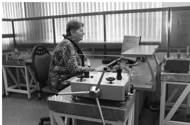
Представитель Челябинского ЦСМ проводит поверку калибратора давления
