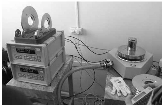
Калибровка на эталоне PG7601 калибраторов-контроллеров давления РРС3 с относительной погрешностью 0,008%
