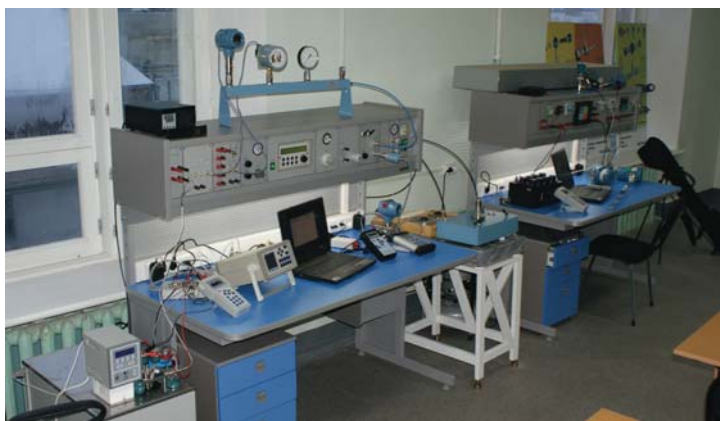
Фото 1. Универсальный стенд с использованием калибраторов и эталонов для поверки средств измерений в радиомеханическом техникуме в г.Йошкар-Ола
