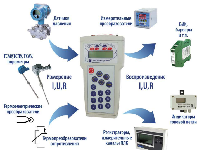
Рис. 2 Поверка (калибровка) приборов с помощью калибратора Метран-510-ПКМ
