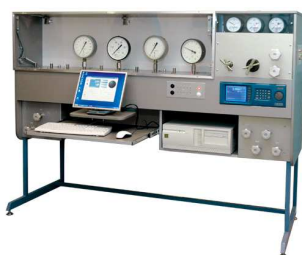
Рис. 5 Стенды для поверки (калибровки) манометров с ручным, автоматизированным или автоматическим заданием давления
