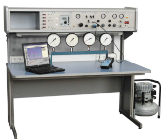
Рис. 5 Стенды для поверки (калибровки) манометров с ручным, автоматизированным или автоматическим заданием давления
