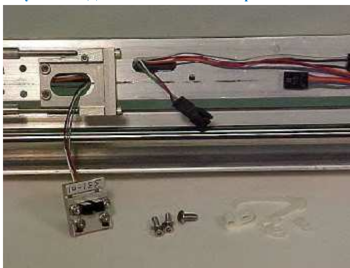
Рисунок 4-14 Демонтаж оптического переключателя №2
