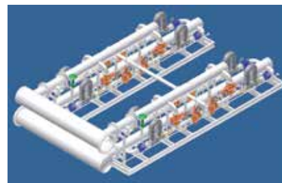
Габаритные размеры системы (м): 13,8 (длина) x 6,6 (ширина) x 2,9 (высота) Номинальный измеряемый расход: 8000 м 3 /ч
