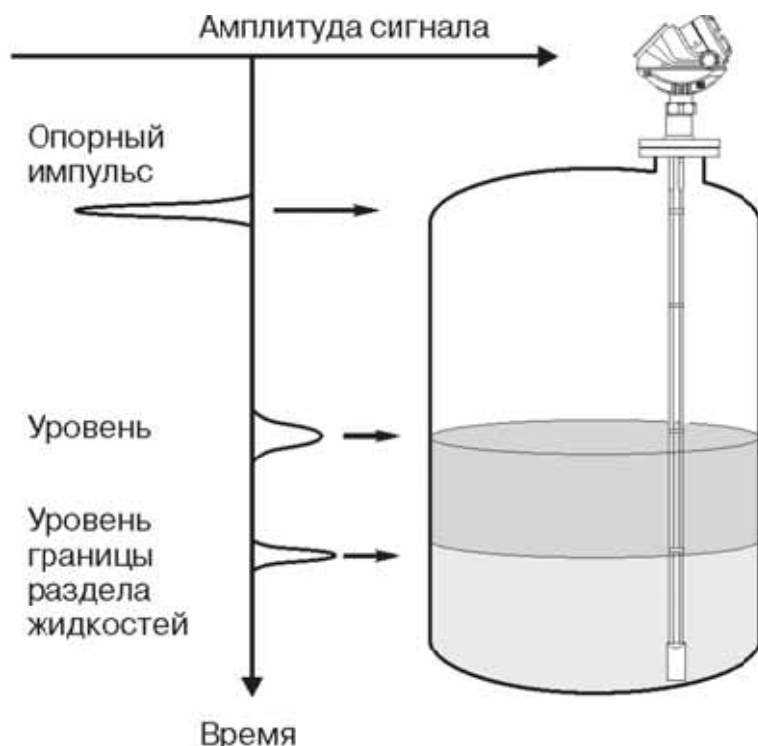
Рис. 47. Вид распространения радарного импульса в измерительной среде
