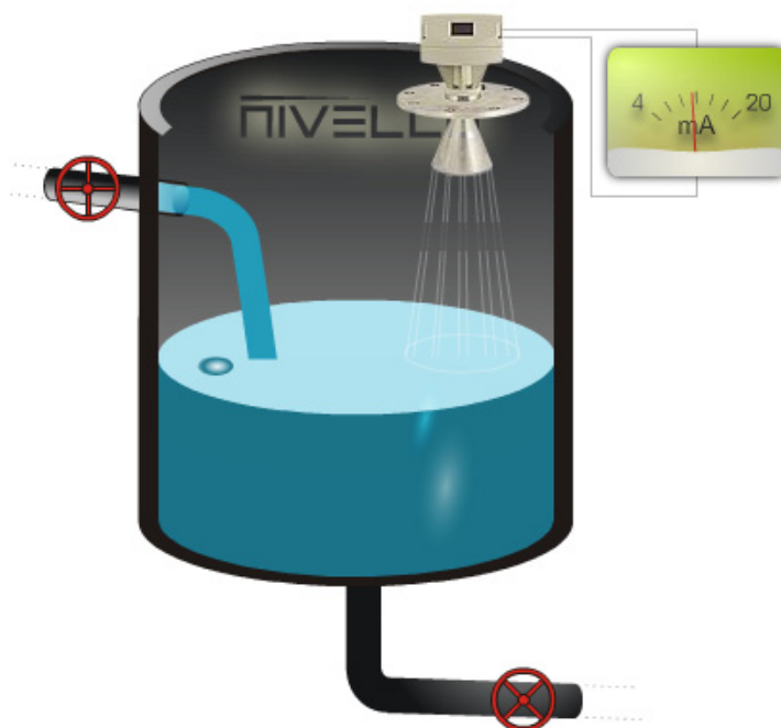
Рис. 32. Емкость с микроволновым радарным уровнемером, производитель Nivelco, Венгрия [6]
