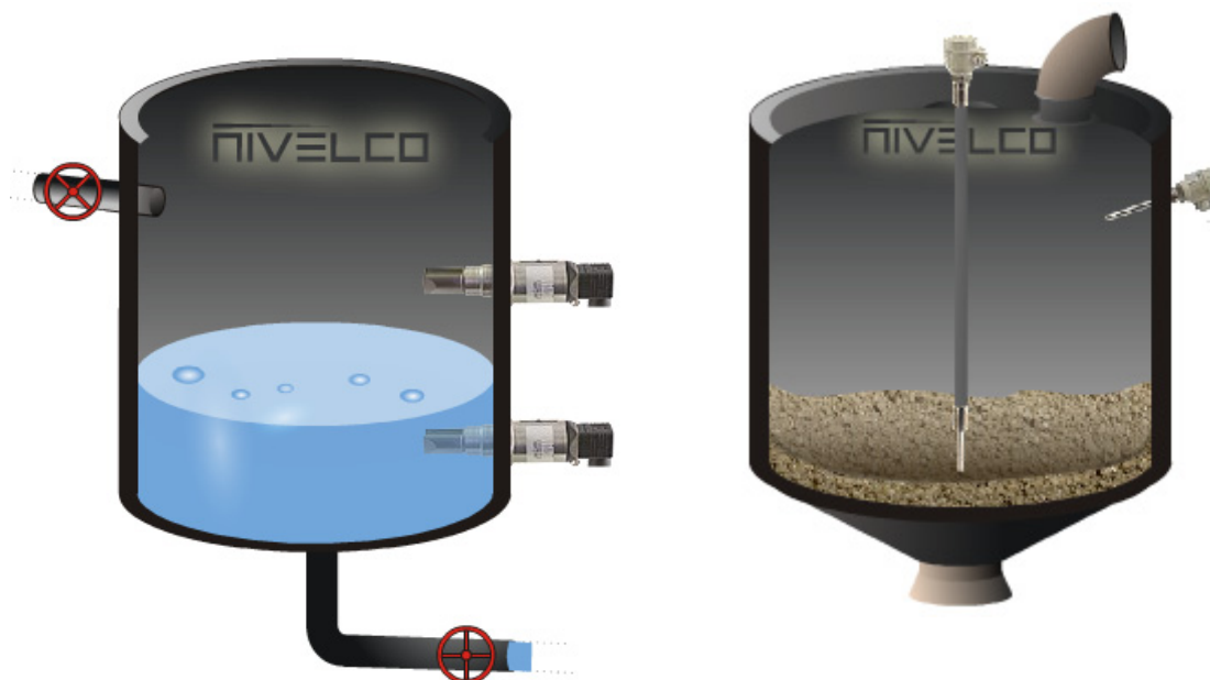
Рис. 24. Емкости с вибрационными сигнализаторами уровня Nivoswitch, производитель Nivelco, Венгрия
