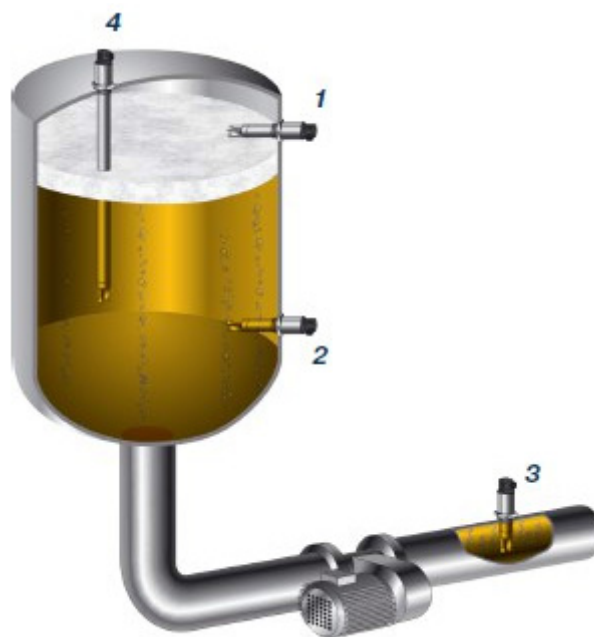
Рис. 26. Применение вибрационного сигнализатора уровня: 1 – определение максимального уровня в емкости; 2 – определение минимального уровня в емкости; 3 – защита насоса от «сухого» хода; 4 – удлиненное исполнение датчика для определения уровня при вертикальном монтаже
