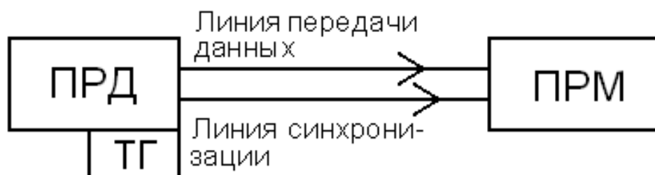
Рис. 2.4. Синхронная передача сигнала
