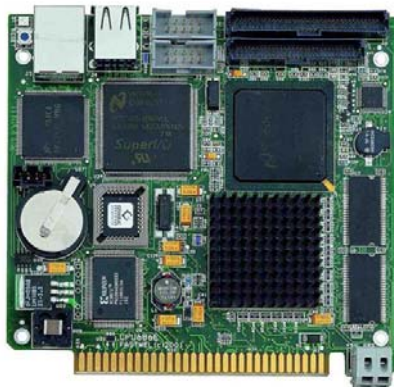
Рис. 4.14. Высокопроизводительная процессорная плата в формате MicroPC с поддержкой Ethernet и CompactFlash фирмы Fastwel CPU686E
