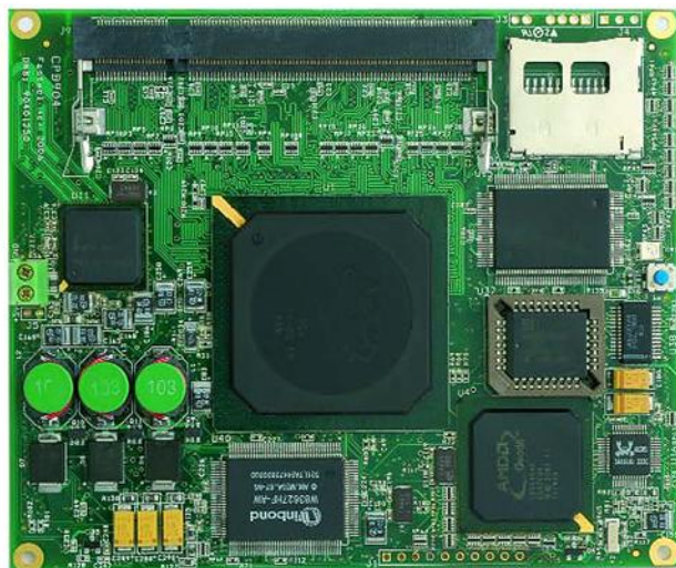
Рис. 4.9. Одноплатный компьютерный модуль CPB904 фирмы Fastwel стандарта ETX с низким энергопотреблением и компактными габаритными размерами 114×95 мм
