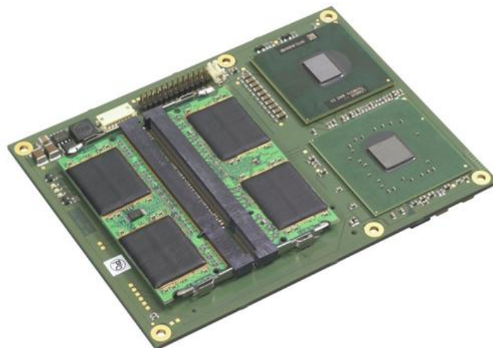
Рис. 4.11. Модуль COM-Express Toucan фирмы LiPPERT на базе процессора Intel Core Duo
