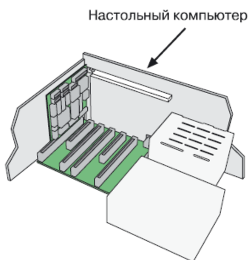
Рис. 4.17. Вариант 1: платы расширения устанавливаются в ISA-слоты компьютера
