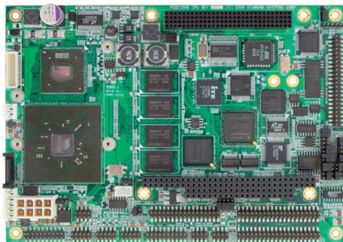
Рис. 4.8. Одноплатный высокопроизводительный компьютер Poseidon формата EPIC с интегрированным модулем UCO фирмы DIAMOND SYSTEMS
