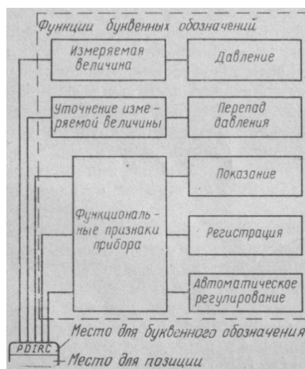
Рис. VII-1. Пример построения условного обозначения комплекта приборов для измерения, регистрации и автоматического регулирования перепада давления.
