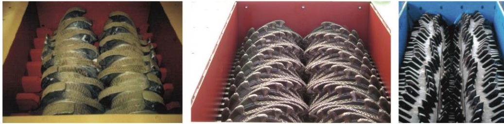
Рисунок 2.8 — Роторы валковых дробилок для крупного, среднего и мелкого дробления фирмы Bedeschi
