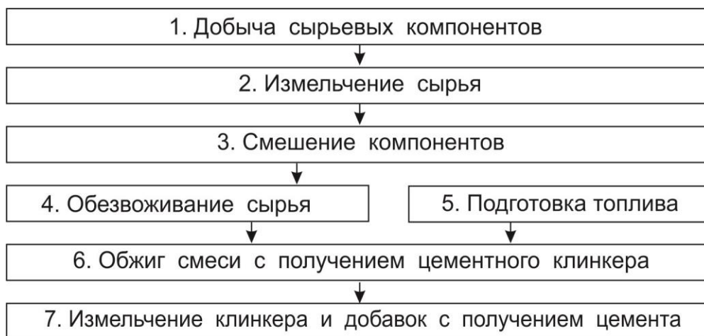
Рисунок 2.1 — Стадии производства портландцемента
