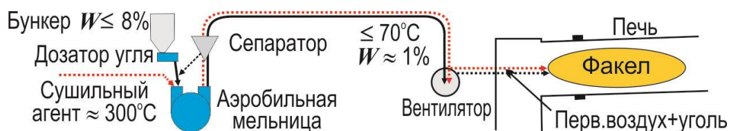
Рисунок 2.26 — Система прямого вдувания угольного порошка в печь 1)
