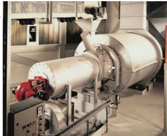
Рисунок 2.69 — Трехходовая барабанная сушилка фирмы GEBR. PFEIFFER
