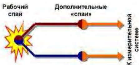
Рис. 3.2. Схема подключения термопары без стабилизации температуры холодного спая
