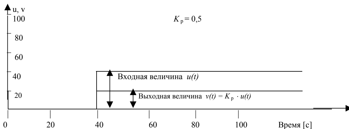
Рис. 1.2 Переходная характеристика P-регулятора в разомкнутом контуре
