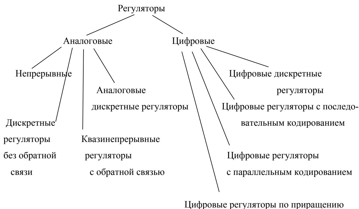
Рис. 1.7 Обзор различных регуляторов по DIN 19225
