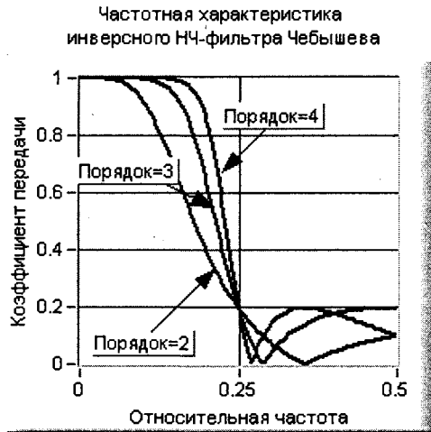
Рис. 3.21. Амплитудно-частотная характеристика инверсного фильтра Чебышева
