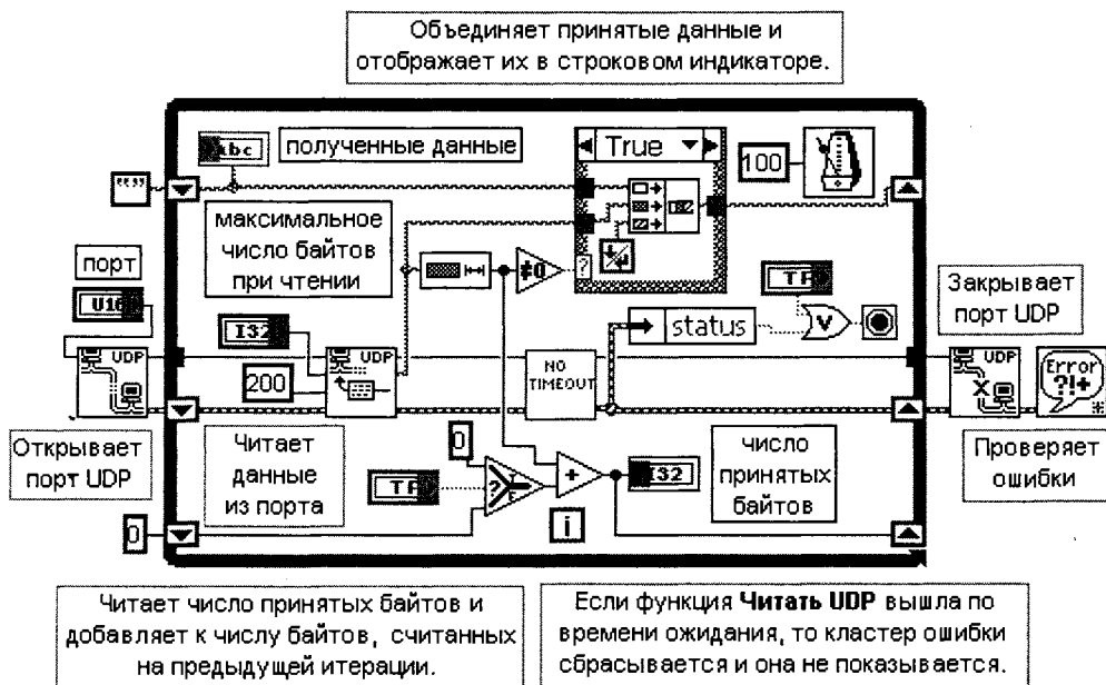
Рис. 4.27. Блок-диаграмма ВП Получатель UDP (UDP Receiver)
