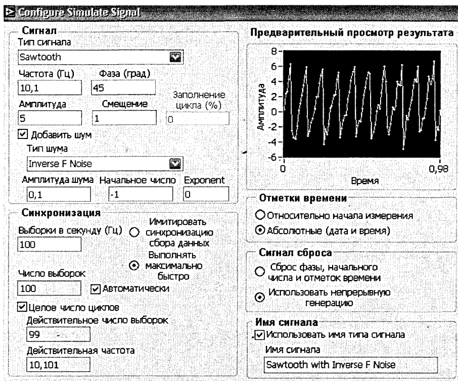
Рис. 5.20. Вид диалогового окна конфигурирования Экспресс-ВП Имитировать сигнал (Simulate Signal)
