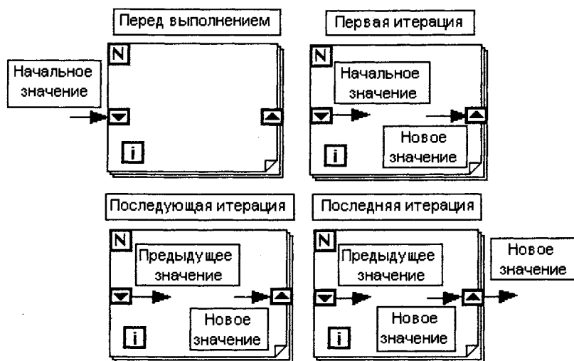
Рис. 1.7. Принцип работы сдвиговых регистров
