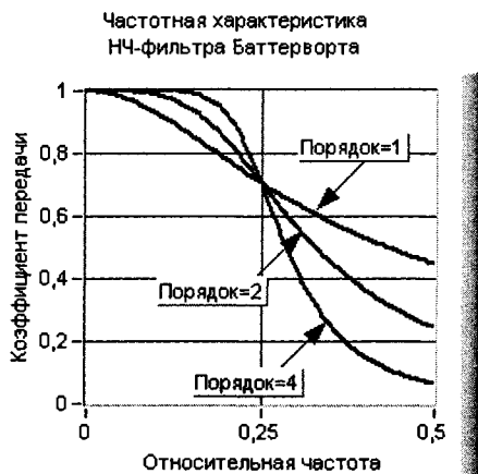
Рис. 3.19. Амплитудно-частотная характеристика фильтра Баттерворта
