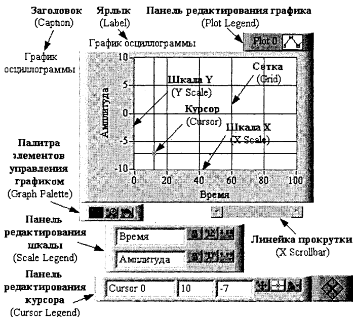
Рис. 1.19 Вид графика осциллограммы с панелями и атрибутами
