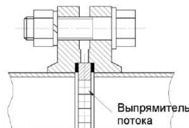
Рисунок 2.8 - Схема монтажа выпрямителя потока
