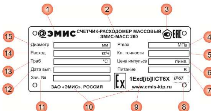
Рисунок 1.5 - Основная табличка расходомера
