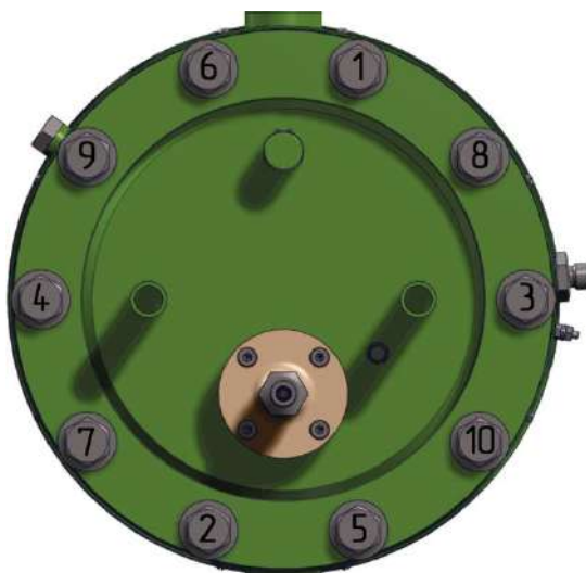
Рисунок 2.5 – Последовательность затяжки болтов фланца
