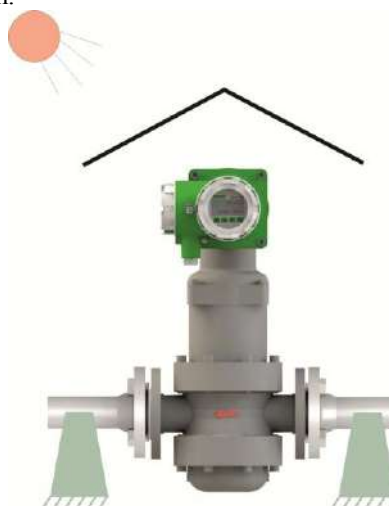
Рисунок. 2.5 - Общие требования к месту установки счетчика
