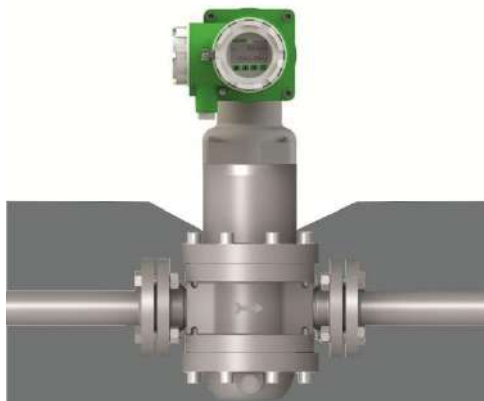
Рисунок 2.11 - Рекомендации по теплоизоляции счетчика
