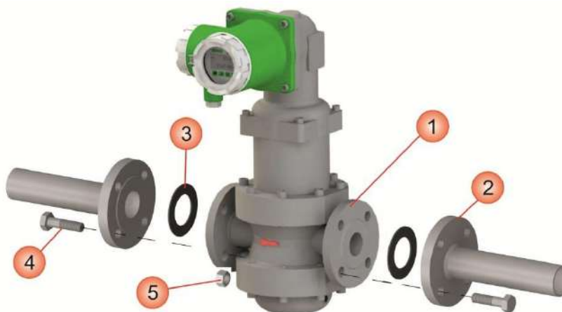
Рисунок 2.9 - Установка счетчика ЭМИС-ДИО 230 на трубопровод
