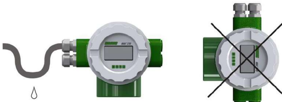
Рисунок 2.8 - Рекомендации по расположению кабелей и кабельных вводов
