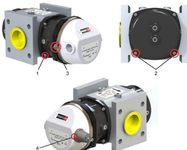
Рисунок 1.9 – Схема пломбирования счетчика
