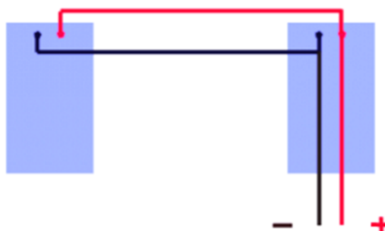
Рисунок 2.28 – Параллельное подключение солнечных панелей.
