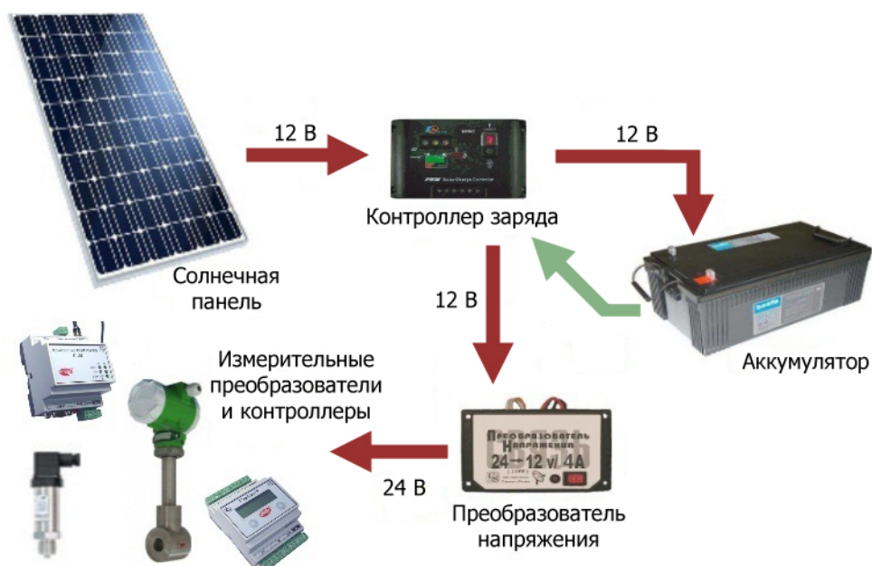
Рисунок 2.27 – Схема подключения узла в составе с солнечными
