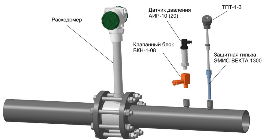
Рисунок 2.20 – Монтаж преобразователя давления и температуры
