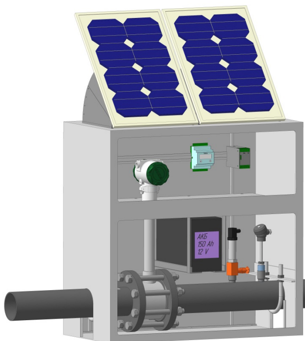
Рисунок 2.24 - Внешний вид узла учета в составе с солнечной панелью
