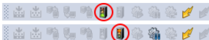
Рис. 39 – Кнопки «Stop Resource(s)» (сверху) и «Start Resource(s)» (снизу) панели инструментов «Target Execution»
