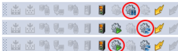
Рис. 40 – Кнопки «Cycle-to-Cycle Mode» (сверху), «One Cycle» (в центре) и «Real Time Mode» (снизу) панели инструментов «Target Execution»
