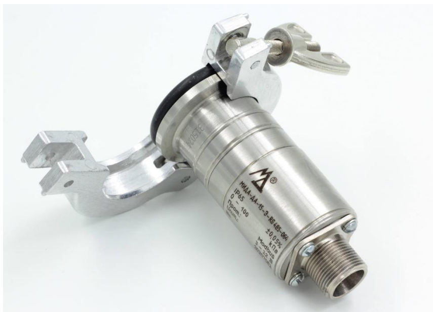
Рис. 2. Эталонный датчик абсолютного давления МИДА-ДА-15-Э с хомутом для присоединения к вакуумной системе.
