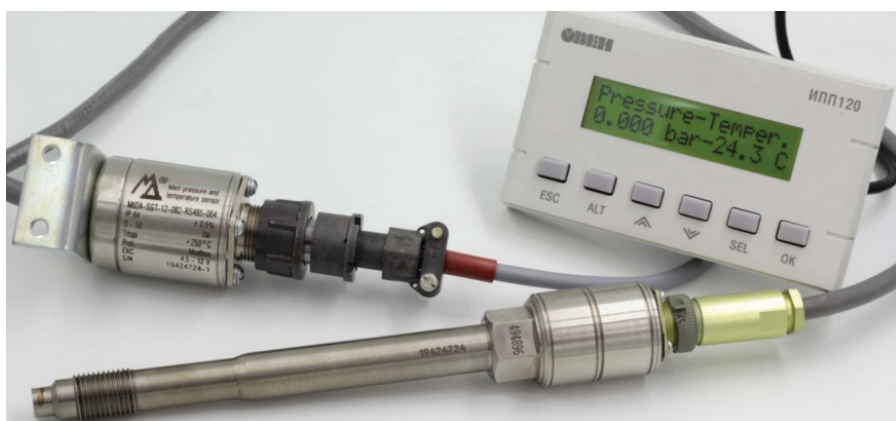
Рис. 3. Датчик давления-температуры расплавов полимеров
